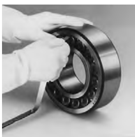
Rys. 1. Sprawdzanie luzu łożyska na podstawie.
